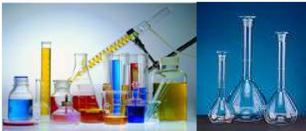
Gambar 2.3. Beberapa Alat pengukur volume, yaitu gelas ukur, beaker glass, erlenmeyer dan labu ukur.
